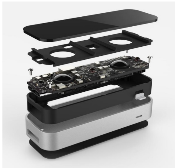
Figura 1.2 Perspectivă expandată a Leap Motion-ului [1]
